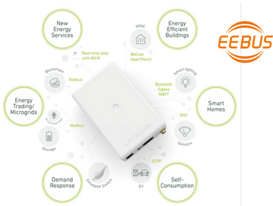
Abb. 2: Das Smappee Genius Gateway ermöglicht verschiedene Energiedienstleistungen und – Steuerungen auf Basis der EEBUS-Kommunikation.
